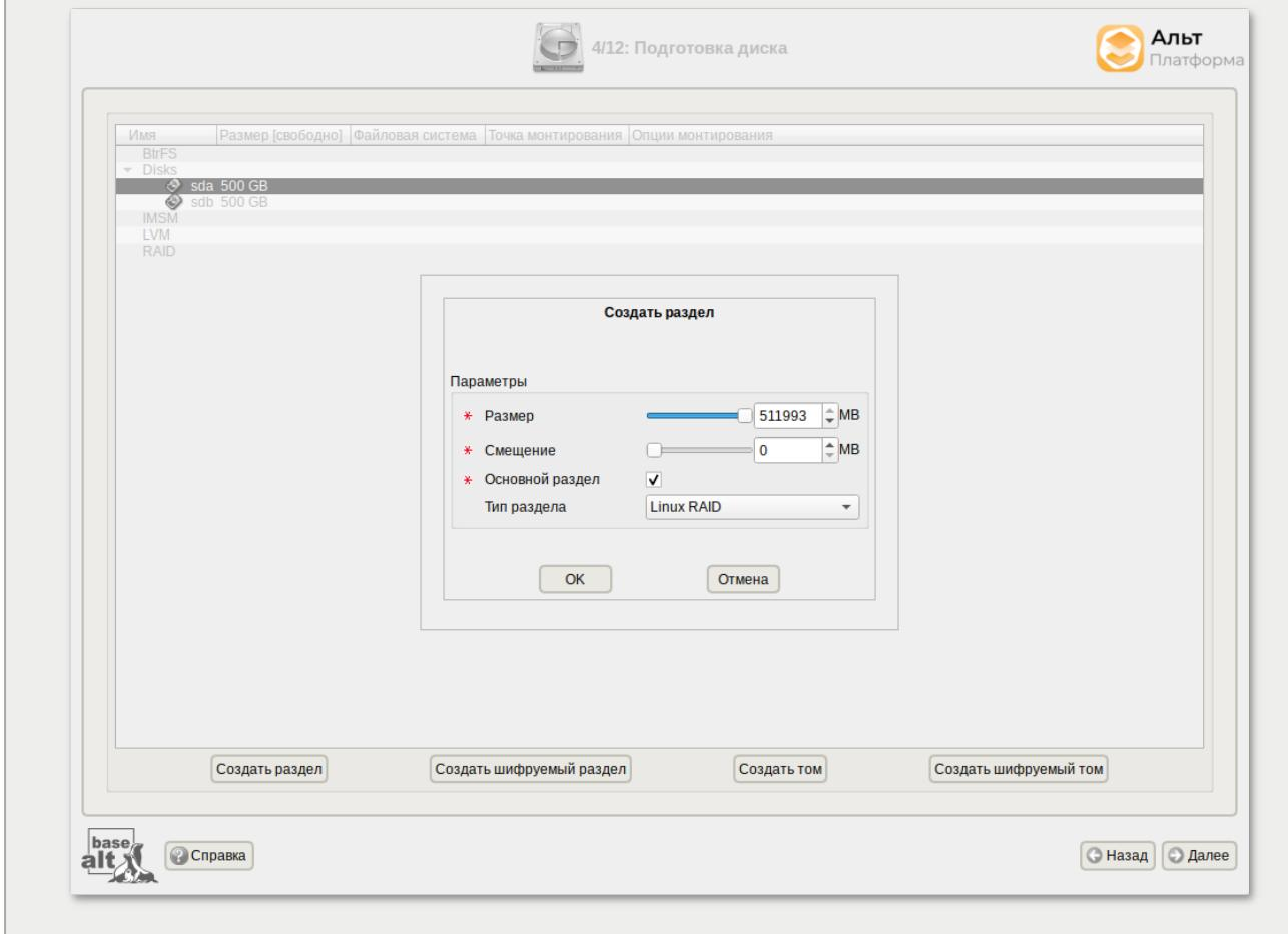
На втором диске создать два раздела с типом **basic data** без создания на них томов. При этом разделы на разных дисках должны совпадать по размеру.
