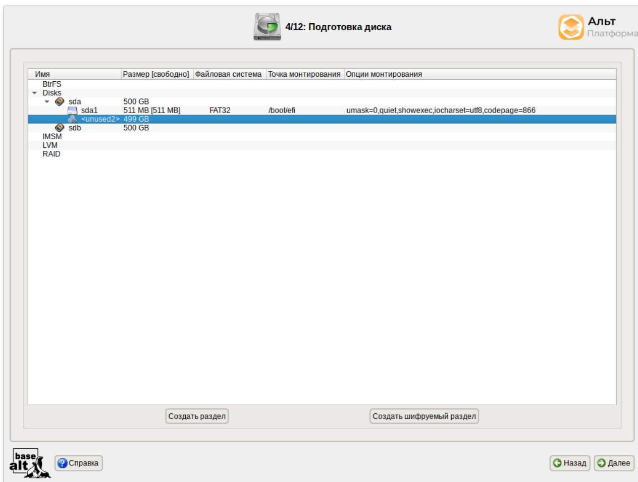
Для создания программного массива на GPT-разделах следует сначала создать разделы типа **basic data** и не создавать на них том (снять отметку с пункта **Создать том**):
