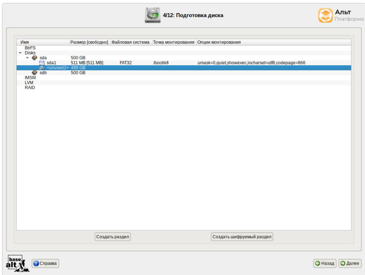
При создании разделов на жёстких дисках для последующего включения их в LVM-тома следует указать **Тип раздела** для них равным **basic data** и не создавать на них том (снять отметку с пункта **Создать том**):
