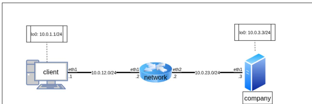
Для работы создайте 3 [клона](#) согласно топологии сети. Для создания соединений между машинами необходимо в VirtualBox настроить сетевые интерфейсы (описание настройки подключения находится в соответствующем [разделе](#) второй лабораторной):
