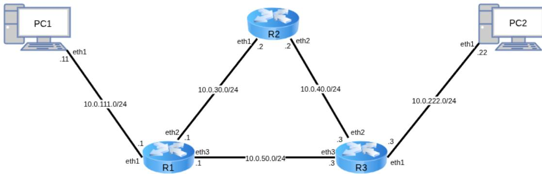
Для работы необходимо 5 [клонов](#) согласно топологии сети. Для создания соединений между машинами необходимо в VirtualBox настроить сетевые интерфейсы (описание настройки подключения находится в соответствующем [разделе](#) второй лабораторной):
