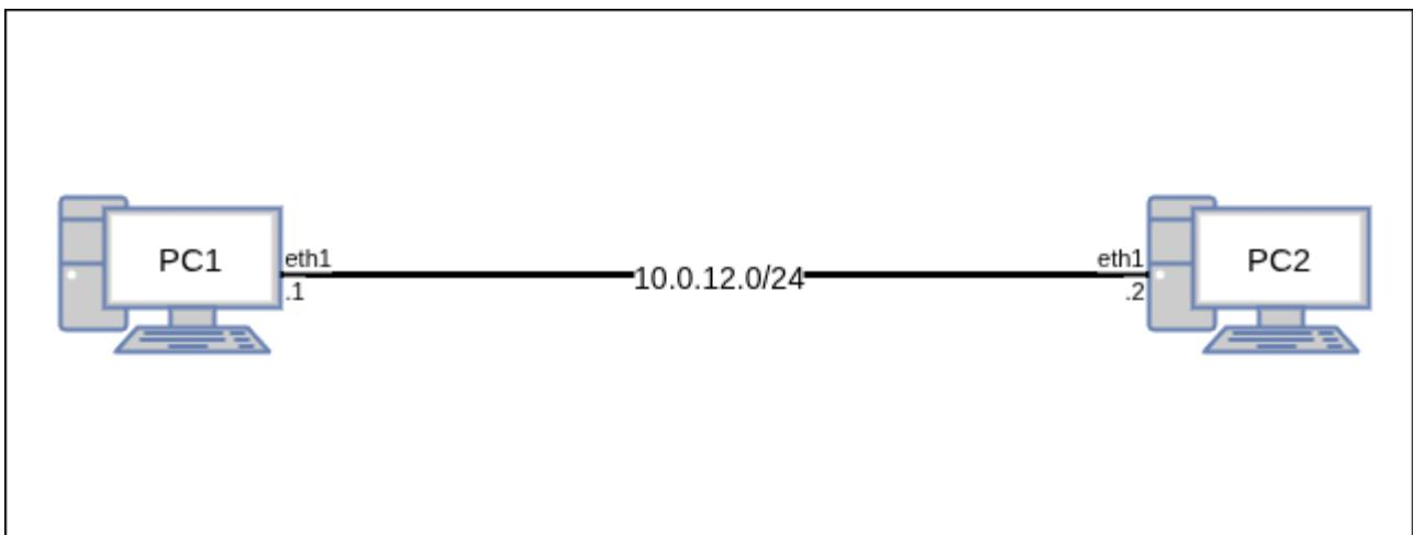
Для работы создайте 2 [клона](#) согласно топологии сети. Для создания соединений между машинами необходимо в VirtualBox настроить сетевые интерфейсы (описание настройки подключения находится в соответствующем [разделе](#) второй лабораторной):
