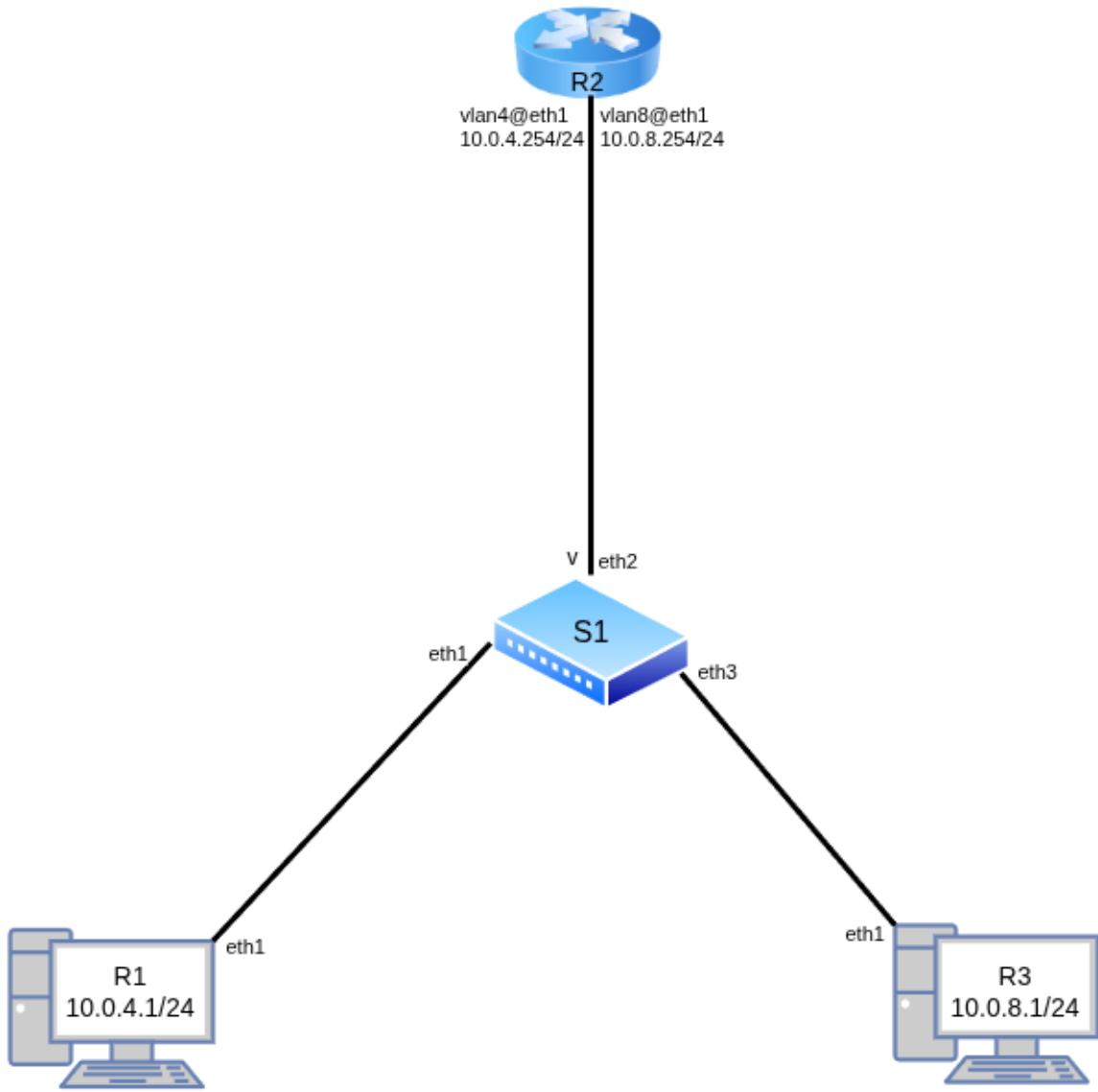
Для работы создайте 4 [клона](#) согласно топологии сети. Для создания соединений между машинами необходимо в VirtualBox настроить сетевые интерфейсы (описание настройки подключения находится в соответствующем [разделе](#) второй лабораторной):
