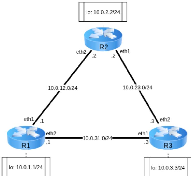
Для работы создадим 3 [клона](#) согласно топологии сети. Для создания соединений между машинами необходимо в VirtualBox настроить сетевые интерфейсы (описание настройки подключения находится в соответствующем [разделе](#) второй лабораторной):
