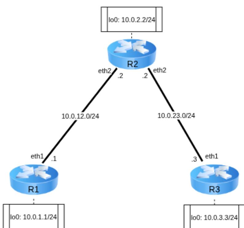
Для работы создайте 3 [клона](#) согласно топологии сети. Для создания соединений между машинами необходимо в VirtualBox настроить сетевые интерфейсы (описание настройки подключения находится в соответствующем [разделе](#) второй лабораторной):
