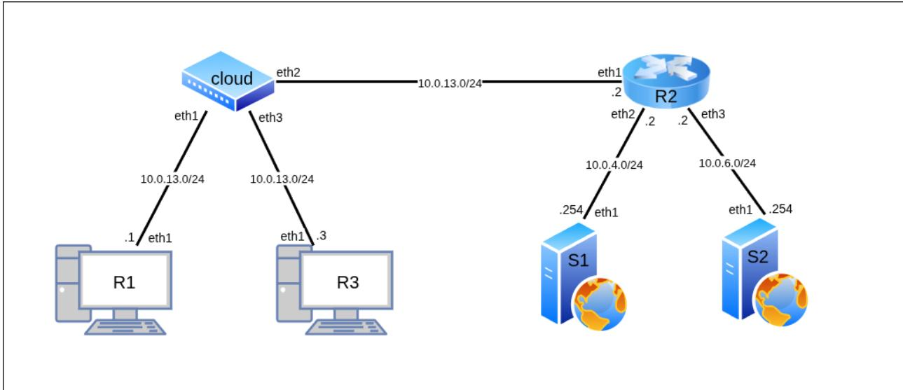
Для работы создадим 6 [клонов](#) согласно топологии сети. Для создания соединений между машинами необходимо в VirtualBox настроить сетевые интерфейсы (описание настройки подключения находится в соответствующем [разделе](#) второй лабораторной):
