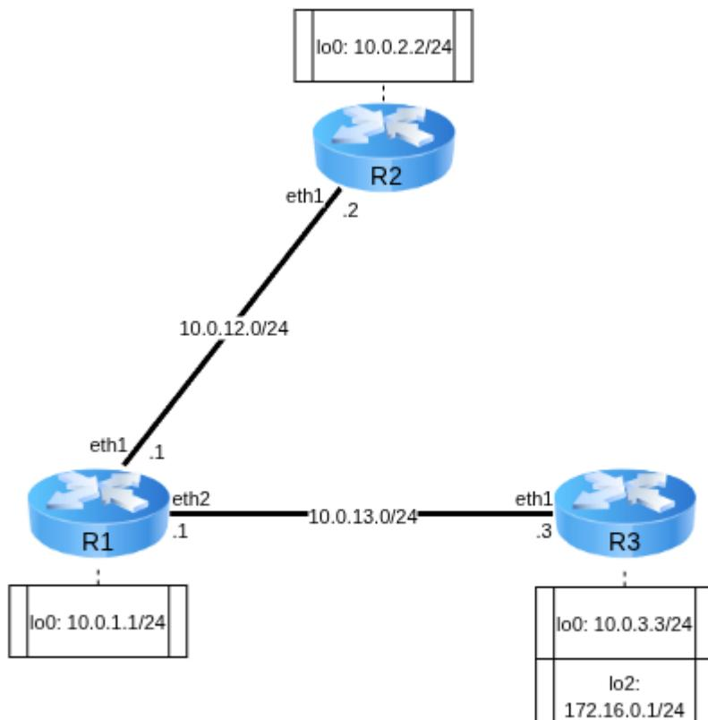
Для работы создайте 3 [клона](#) согласно топологии сети. Для создания соединений между машинами необходимо в VirtualBox настроить сетевые интерфейсы (описание настройки подключения находится в соответствующем [разделе](#) второй лабораторной):
